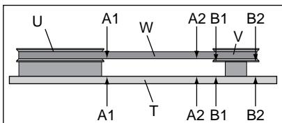
deben estar alineados (en el mismo plano) dentro de una distancia de 1,6 mm (1/16 pulg.) para asegurar la retención de la correa dentro de las ranuras del volante. Para controlar la alineación:
