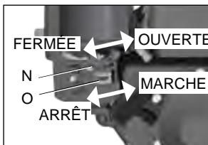
10. Mettre le système de blocage de la soupape de décompression en position **fermée** de sorte que la pression puisse s'accumuler.
